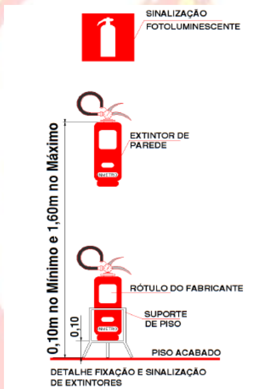
Figura 1 – Fixação do extintor
