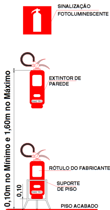
Figura 3 – Detalhe de fixação e sinalização do extintor
